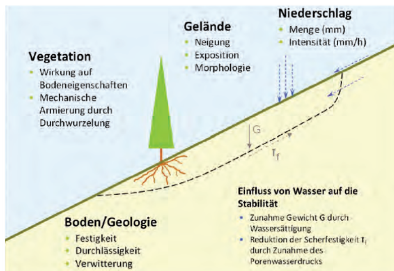
Abbildung 1: Einfluss verschiedener Faktoren auf die Hangstabilität (Rickli, 2001) aus [6]
